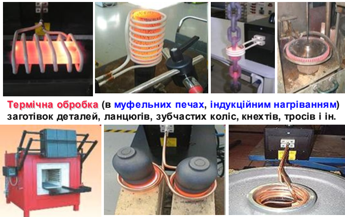
Рисунок 11 – Приклади обладнання та технології термічної обробки виробів
