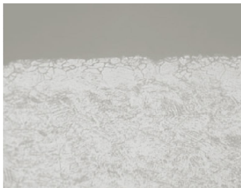
Рисунок 2 – Микроструктура азотированного слоя стали 12Х18Н9Т
