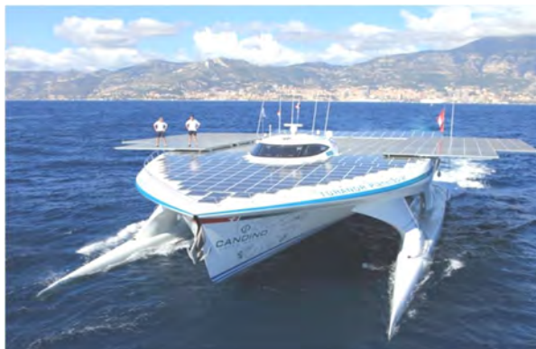
Рисунок 9 – Катамаран « Turanor Solar Planet », работающий на солнечных батареях (Германия)
