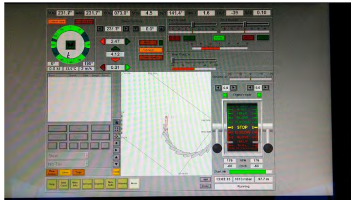
Рисунок 19 – Модель Ro-go passenger ferry 13. Положення ПП між міделем та кормою на ходові назад під час повороту праворуч
