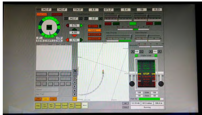
Рисунок 16 – Модель OSV 3 АН. Положення ПП між міделем та кормою на ходові назад під час повороту ліворуч
