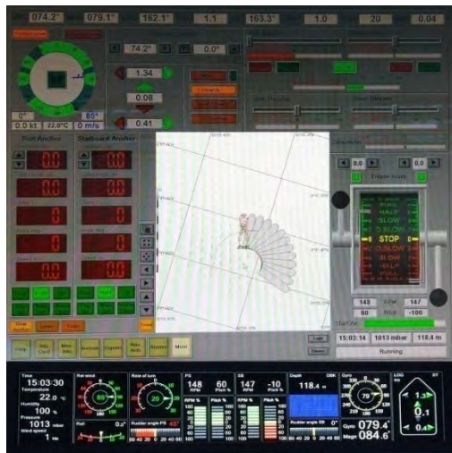
Рисунок 10 – Положення ПП позаду корми судна під час обертання праворуч
