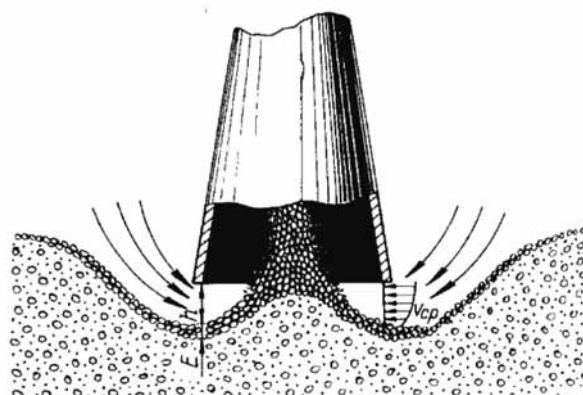
Рис. 1. Схема всасывания неразмытого грунта в подводном забое
