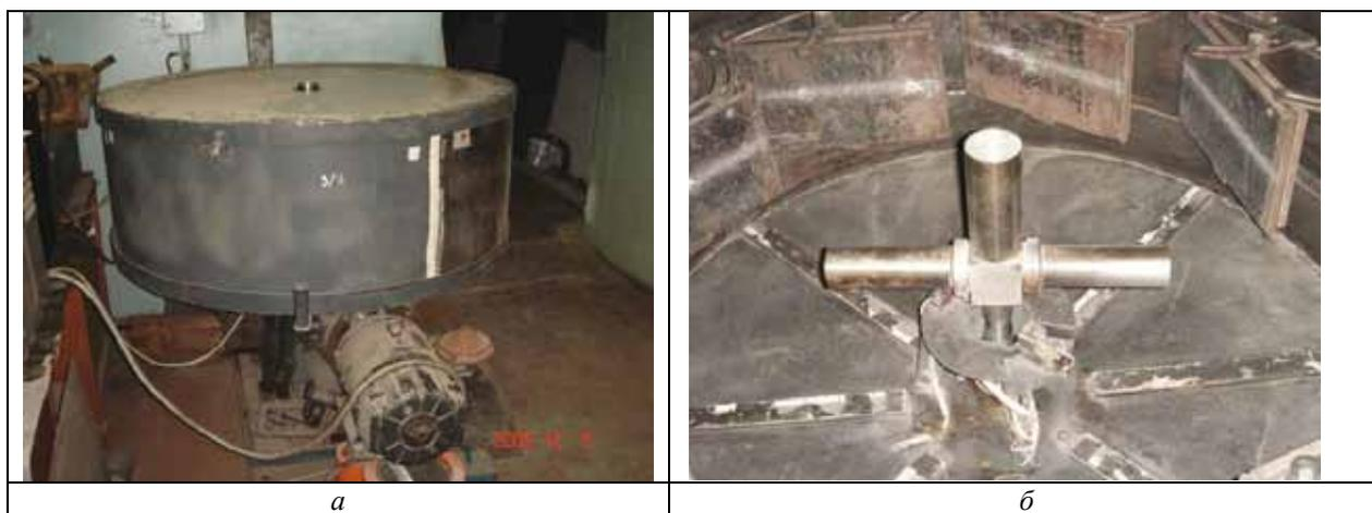
Рис. 1. Центробежная установка для ударных испытаний материалов: а – общий вид стенда; б – вращающаяся каретка стенда
