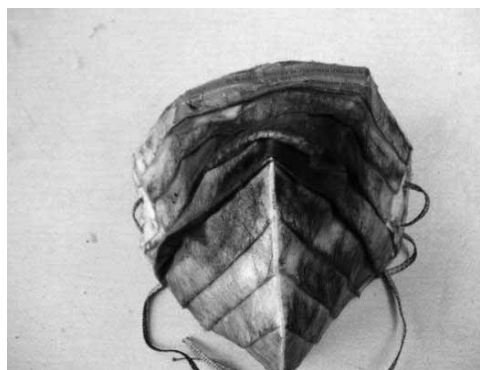
Рис. 4. Вигляд респіатора після запылення на циклічному потоці
