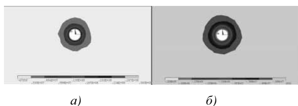
Рис. 1. Картины распределения главных напряжений \sigma_1 (а) и \sigma_3 (б) в модели при помещении НРС непосредственно в шпур и давлении саморасширения 30 МПа
