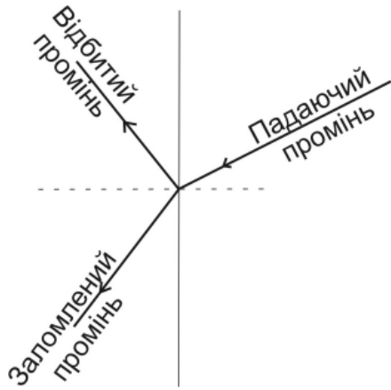
Рис. 1. Віддзеркалення та заломлення лазерного променя на оптично гладкій межі розділу поверхонь
