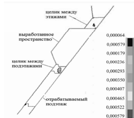
Рис. 5. Формирование зон горизонтальных пластических деформаций при отработке запасов горизонта +120м (угли средней крепости)
