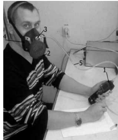
Рис. 1. Загальний вигляд проведення дослідження з визначення перепаду тиску на респіраторі: 1 – електронний манометр Testo 512; 2 – фільтрувальна коробка з фільтром; 3 – пробовідбірник; 4 – півмаска; 5 – повітропровід
