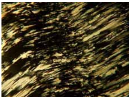
Рис. 5. Хвилястий вигин частково окварцованого паралельно-волокнистого агрегату кумінгтонітового азбесту, що надає мінливості, переливчастості забарвлення сірому соколиному оку. Прохідне світло; без аналізатора; збільшення 160\times
