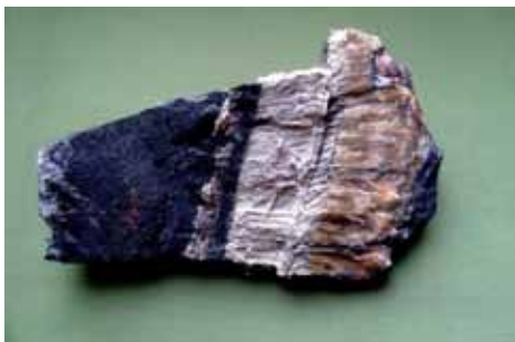
Рис. 4. Зразок з проявом кумінгтонітового азбесту (світло-сіре), що частково заміщений тигровим оком (коричневе). Розмір зразка за максимальним виміром 14 см
