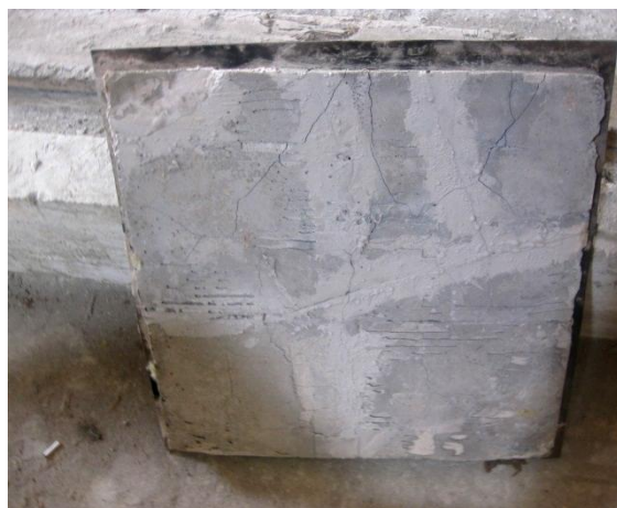
Рисунок 5 — Вигляд дослідного зразка П-2 після випробування.
