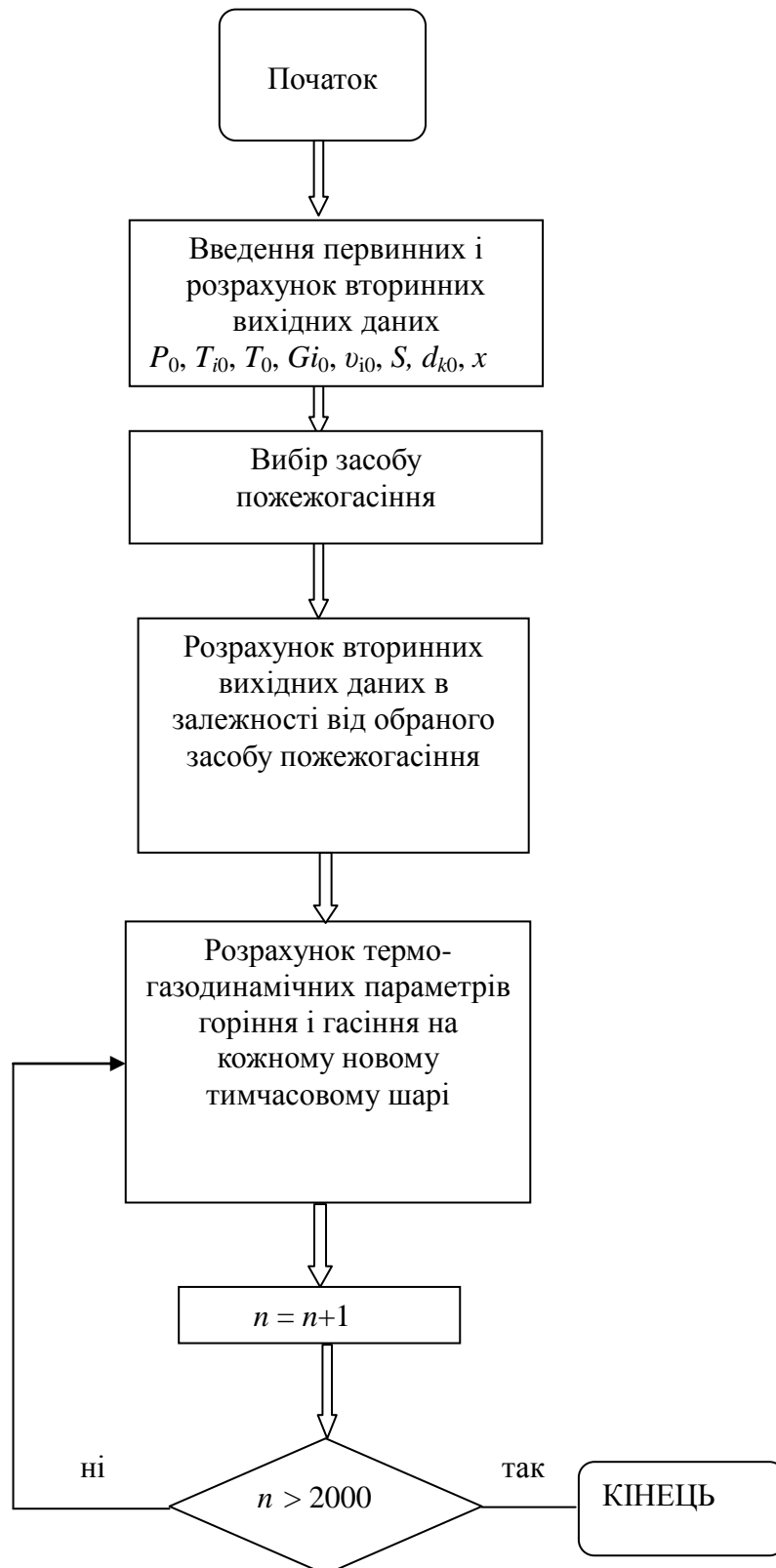
Рисунок 1 — Блок-схема розрахунку термо-газодинамічних параметрів горіння і гасіння пожежі у відсіку кабельного тунелю
