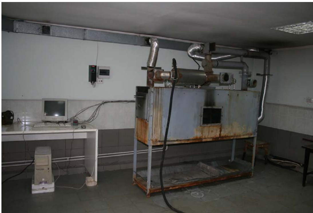
Рисунок 1 — Установка визначення горіння кабелю та ефективності гасіння різними вогнегасними речовинами в закритих об'ємах
