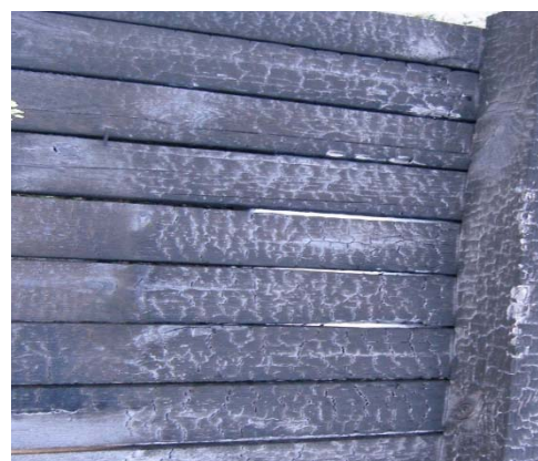
Рисунок 6 — Стан дерев'яної конструкції, що оброблена ВВБЗР ФСГ-2Д, після 720 с впливу вогнища класу В
