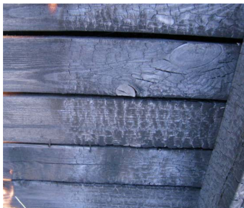
Рисунок 5 — Стан дерев'яної конструкції, що оброблена ВВБЗР ДСА-1, після 720 с впливу вогнища класу В
