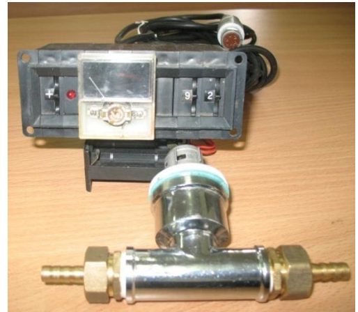
Рисунок 1 – Структурна схема і зовнішній вигляд оптоелектронного октановимірювача з ядерно-магнітним активуванням
