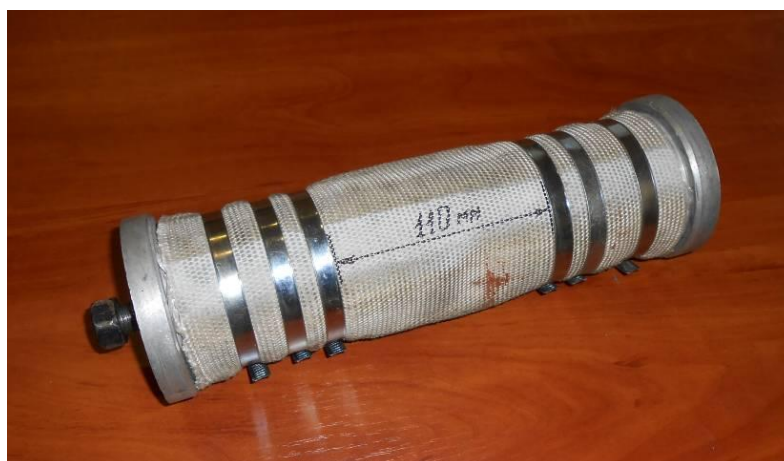
Рисунок 1 – Випробувальний зразок пожежного рукава з внутрішнім діаметром 77 мм.
