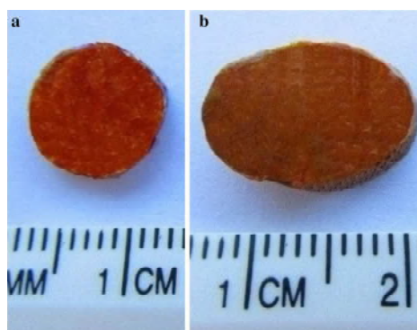
Рис. 12. Шліфи монокристалів а) (\text{Ga}_{55}\text{In}_{45})_2\text{S}_{300} ; б) (\text{Ga}_{54,59}\text{In}_{44,66}\text{Er}_{0,75})_2\text{S}_{300} .
