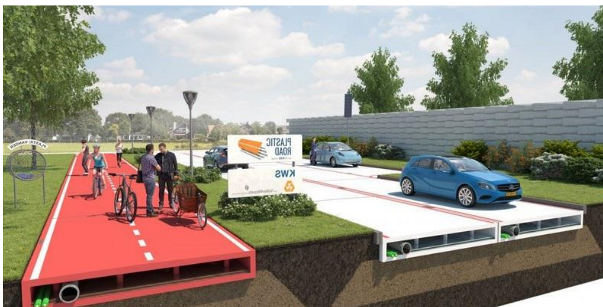
Рис. 3. Пластикові дороги запропоновані голландськими дорожніми компаніями VolkerWessels і KWS Infra*
