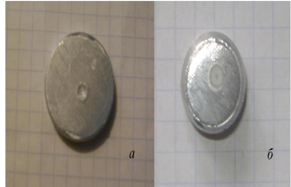
Рис. 3. Вигляд алюмінієвого (а) та дюралюмінієвого (б) електродів після експерименту, який тривав 20 хв.
