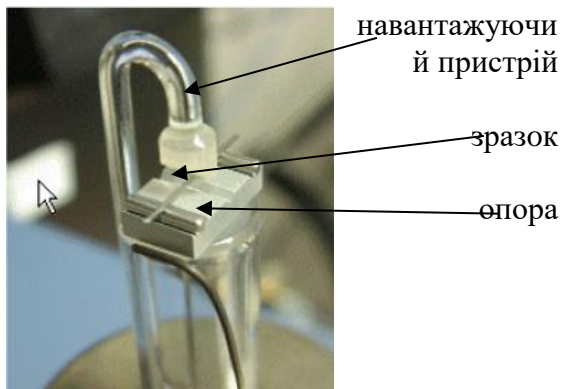
Рис.1. Схема деформування та основні функціональні вузли приладу Q400 ТМА для динамічного механічного аналізу [8].
