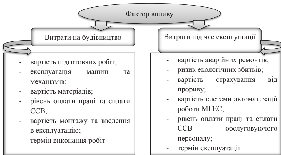
Рис. 1. Система основних факторів впливу на оптимізацію витрат будівництва та експлуатації малих ГЕС
