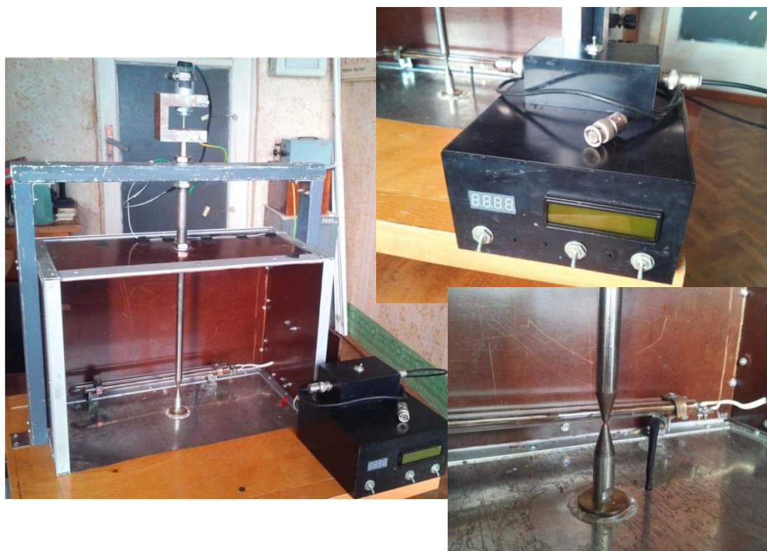
Фото 1. Загальний вигляд установки для дослідження п'єзоелектричних властивостей
