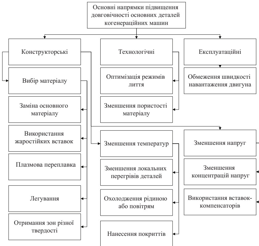
Рис. 2. Схематичне зображення шляхів підвищення довговічності основних деталей когенераційних машин
