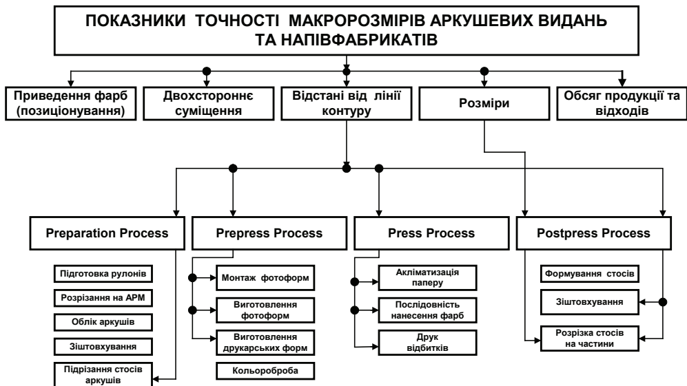
Рис. 2. Схематичне зображення показників, які формують точність макророзмірів аркушевих видань та напівфабрикатів, факторів впливу на окремі з них
