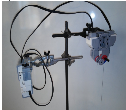
Рис. 4. Зовнішній вигляд установки для дослідження явища резонансу
