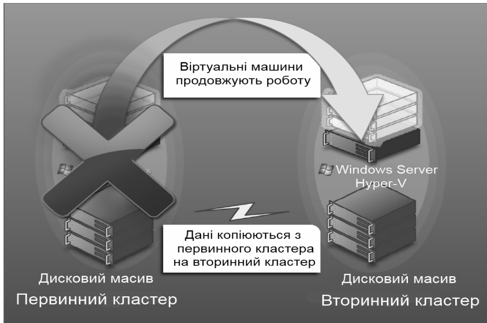
Рис.4. Спрощена схема процесу Live Migration між двома кластерами в межах одного центру обробки даних.
