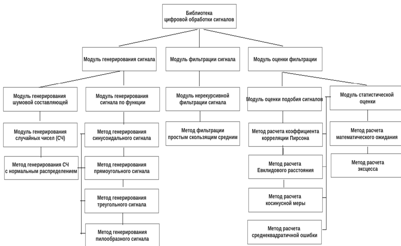
Рис. 1. Структура библиотеки для цифровой обработки сигналов
