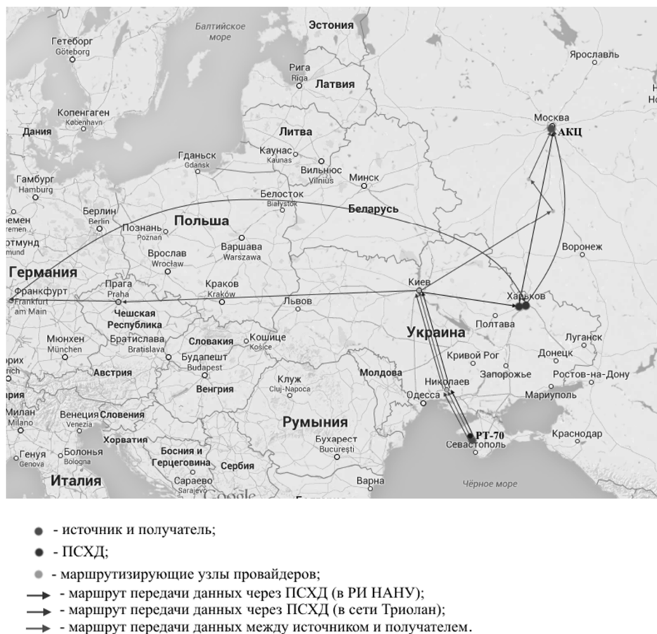
Рис. 1. Схема проведения эксперимента
