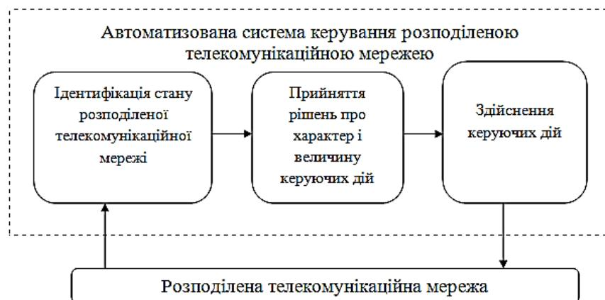
Рис. 8. Інформаційна структура циклу керування в системі управління розподіленою телекомунікаційною мережею
