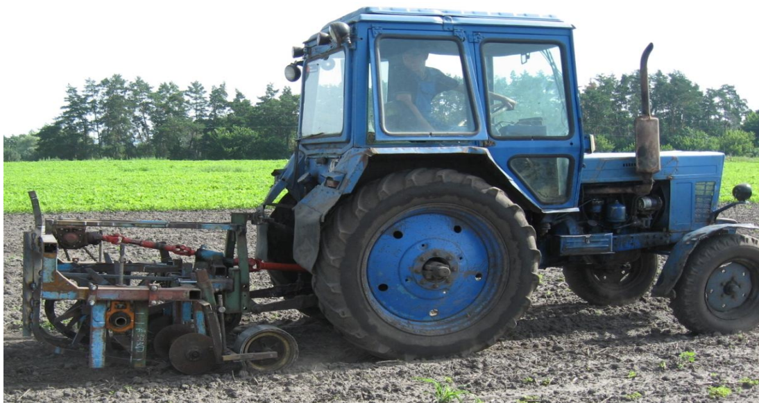
Рисунок 1. Експериментальна установка для оптимізації агрофізичних властивостей ґрунту в агрегаті з трактором МТЗ-80
