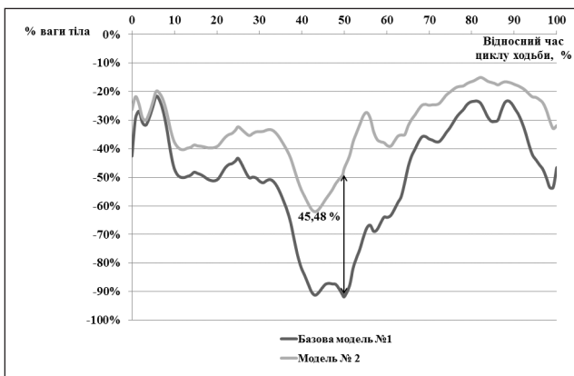
Рис. 8. Зміни проекції вектора сили навантаження кульшової западини на вісь Z у циклі нормальної ходьби людини в моделі № 2 порівняно з базовою моделлю
