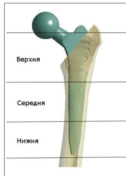
Рис. 2. Схема розташування контрольних точок вимірювань напружено-деформованого стану
