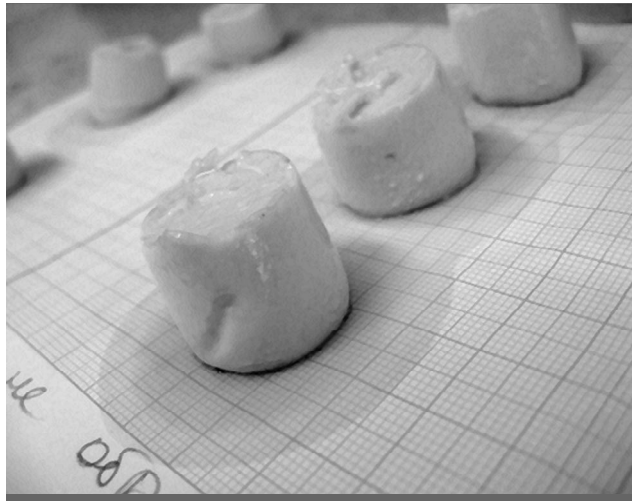
Рисунок 1 – Образцы СМ в процессе определения их термостойкости
