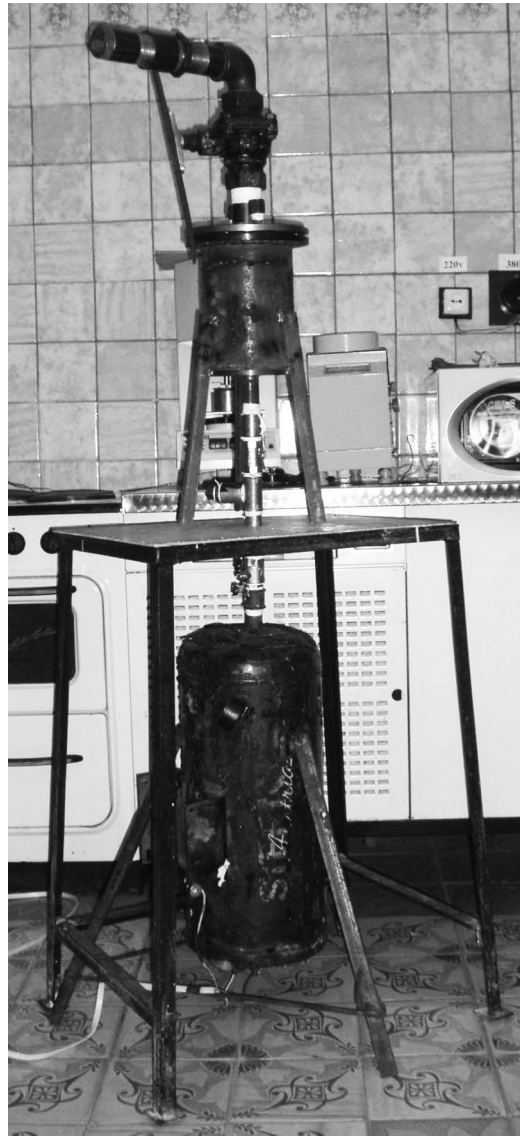
Рисунок 1 — Установка для дослідження впливу термічної обробки на поверхневий шар бульбоплодів
