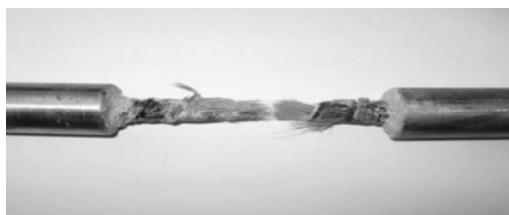
Рис. 5. Втомне руйнування зразка.
