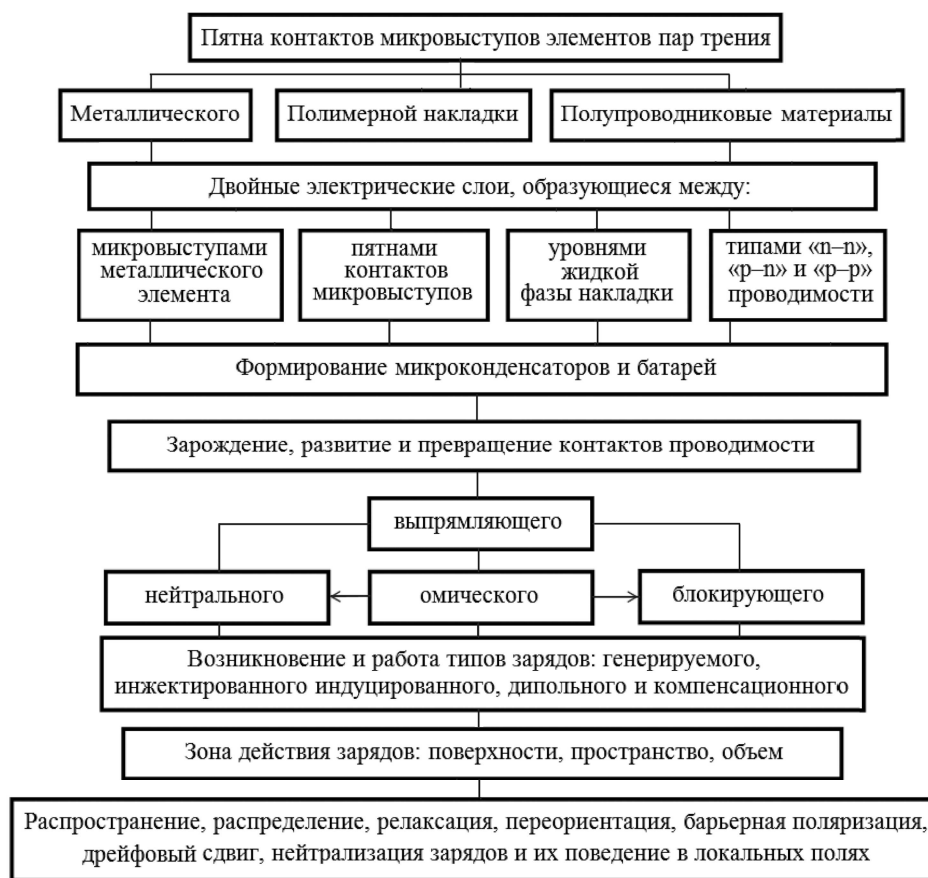
Рис. 2. Энергетические уровни пятен контактов микровыступов элементов пар трения при электротермомеханическом фрикционном взаимодействии со структурой металл–полимер–полупроводники.
