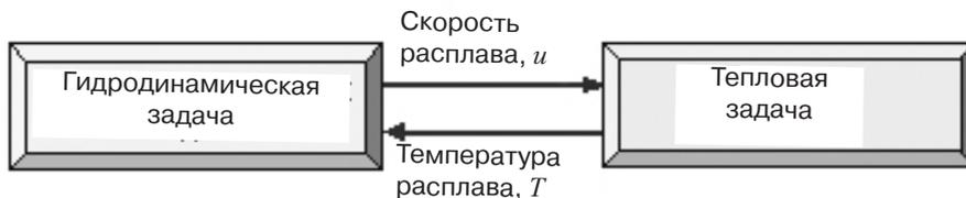
Рис. 2. Структура решаемой мультифизической задачи и передача данных между частными физическими задачами
