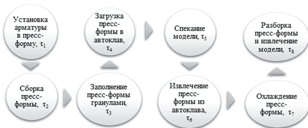
Рис. 1. Цикл изготовления пенополистироловых моделей с армирующими элементами
