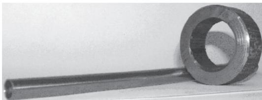
Рис. 2. Фрагменты твельной трубки (слева) и трекс-трубы
