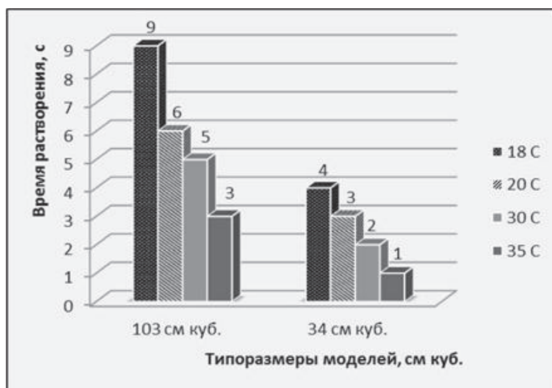
Рис. 2. Зависимость времени растворения моделей из блочного ППС ( \rho = 25 \text{ кг/м}^3 ) от температуры растворителя: а – технический скипидар; б – растворитель № 646
