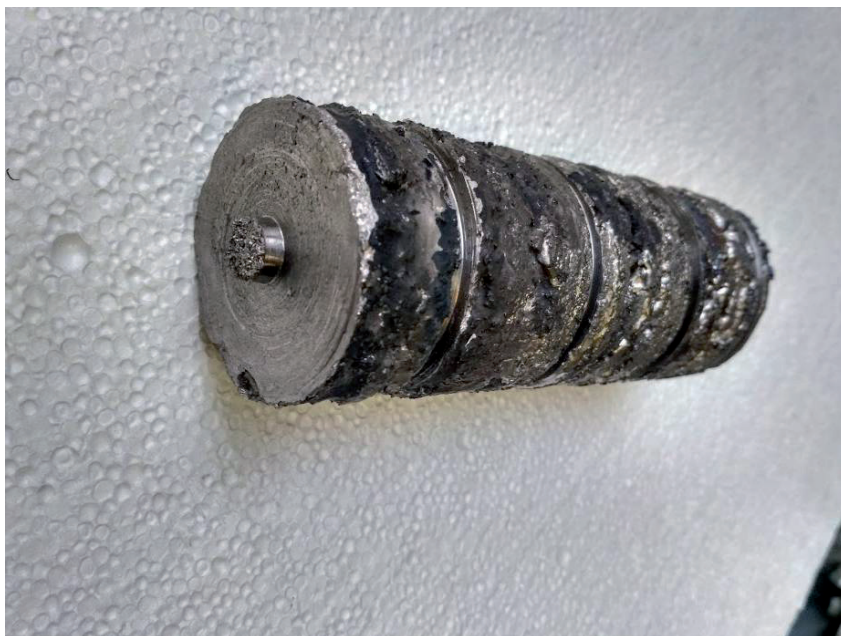
Экспериментальный слиток многокомпонентного сплава системы Nb–Ti–Al, полученный методом электронно-лучевой плавки (ЭЛП) с «промежуточной» емкостью
