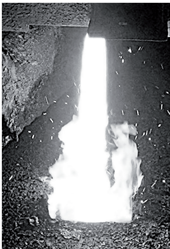
Рис. 3. Веерение струи металла вследствие наличия отложений на внутренней поверхности калибровочной вставки стакана-дозатора
