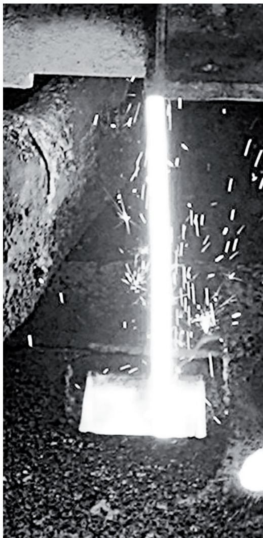
Рис. 6. Разливка металла через опытный стакан-дозатор со стабильной геометрией истекающей струи металла из промежуточного ковша
