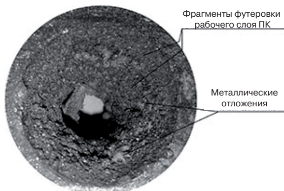
Рис. 4. Фрагменты футеровки промежуточного ковша, отложившейся на калибровочной вставке нижнего стакана-дозатора
