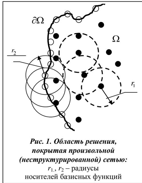
Рис. 1. Область решения, покрытая произвольной (неструктурированной) сетью:  $r_1, r_2$  – радиусы носителей базисных функций
