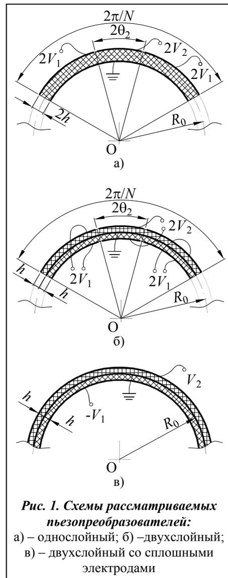
**Рис. 1. Схемы рассматриваемых пьезопреобразователей:**
