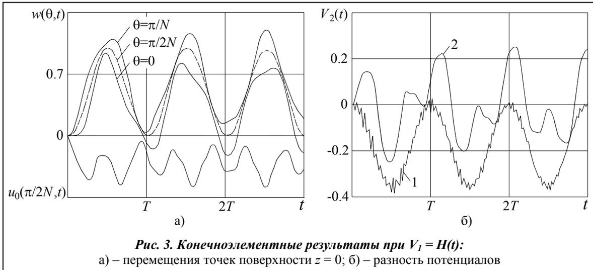
ние расчетных значений  $V_2$  в экстремальных точках составляет менее 8%. Для преобразователя со сплошными электродами конечнэлементные решения задачи в статической постановке составили  $\bar{w} \approx 0.41$  и  $\bar{V}_2 = -0.1779$  (разницы  $\Delta_w \approx 0$  и  $\Delta_V \approx 1\%$ ).
