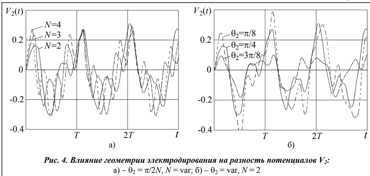
сопровождается ростом пиковых значений выходной разности потенциалов  $V_2$  (рис. 4, б), обусловленное увеличением подводимой электрической энергии к пьезокерамическому преобразователю.
