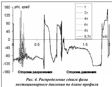
работой сил со знаком «минус» (здесь  $\mathbf{F}$  – аэродинамическая сила на поверхности лопатки;  $\mathbf{w}$  – вектор перемещения лопатки, интегрирование ведется по поверхности лопатки). Положительные значения коэффициента свидетельствуют о демпфировании колебаний, отрицательные – о возможности возбуждения колебаний. На рис. 5 представлена зависимость коэффициента аэродемпфирования от шага по времени.
