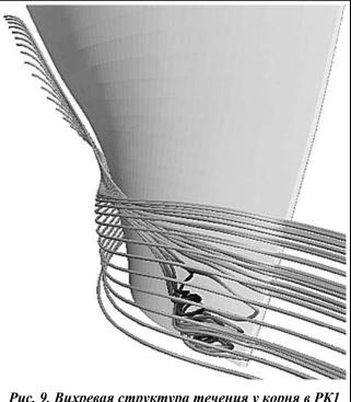
Рис. 9. Вихревая структура течения у корня в РК1
