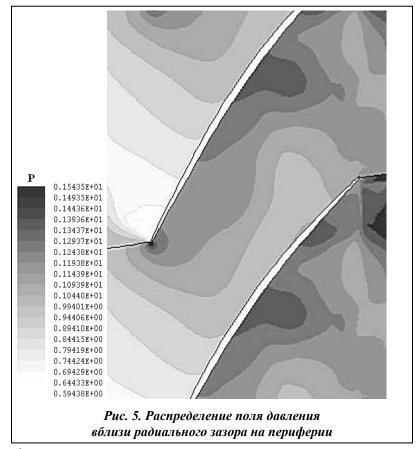
Наличие радиального зазора над венцом рабочих лопаток оказывает существенное влияние на распределение поля давления и работу ступени. При наличии градиента давления между спинкой и корытцем профиля лопатки происходит перетекание газа через зазор. В результате понижения перепада давления уменьшается работа ступени. Распределение поля давления изображено на рис. 5.
