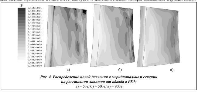
нестационарностью, необходимо определить неоднородности поля, в котором работает аэродинамическая решетка. Окружная неоднородность потока газа является основной причиной возбуждения колебаний лопаточного аппарата, т. е. приводит к непостоянной интенсивности газовой нагрузки. Данная неоднородность потока проявляется в виде неоднородности полей давления и скоростей.
