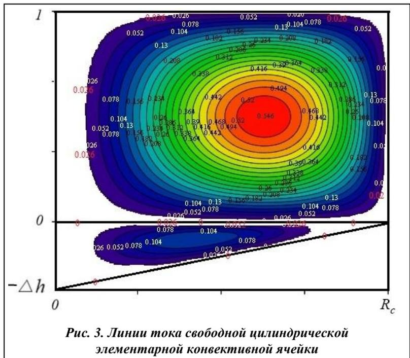
Рис. 3. Линии тока свободной цилиндрической элементарной конвективной ячейки
