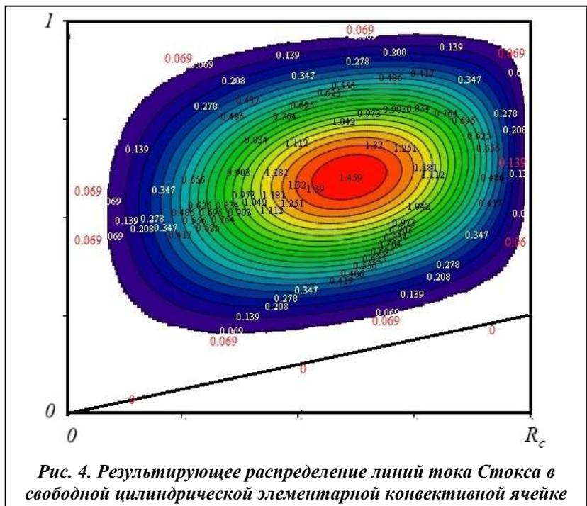
Рис. 4. Результирующее распределение линий тока Стокса в свободной цилиндрической элементарной конвективной ячейке
