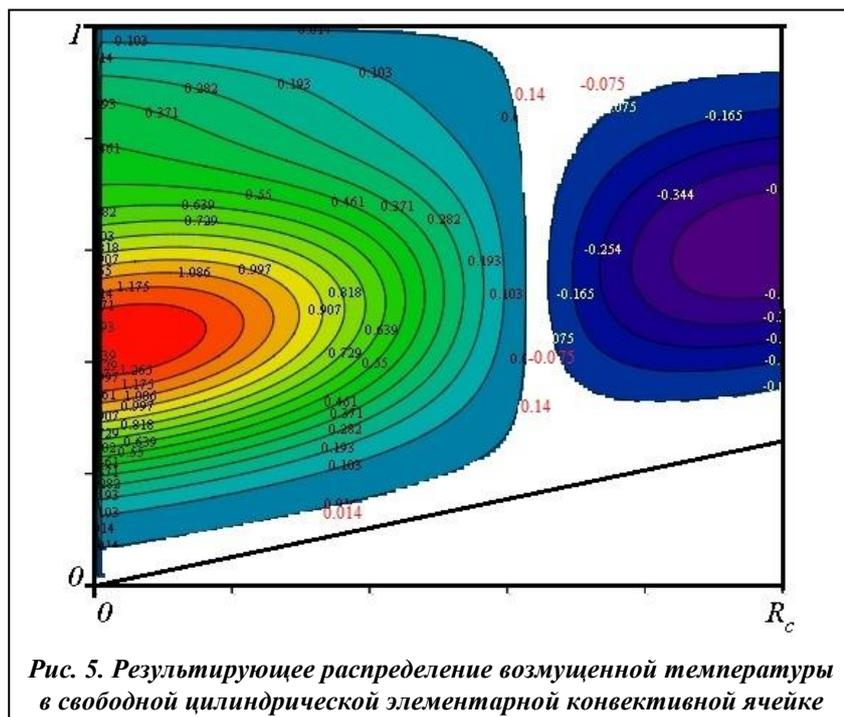
Рис. 5. Результирующее распределение возмущенной температуры в свободной цилиндрической элементарной конвективной ячейке
