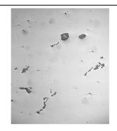
Рис. 3. Вид неметаллических включений в металле вала
